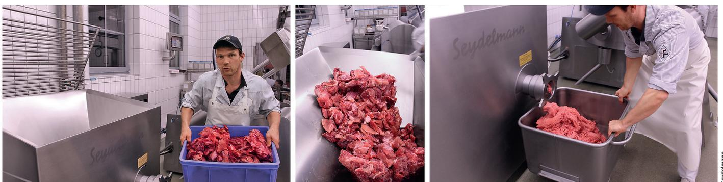
**Der Automatenwolf AE 130 sorgt für ein perfektes Schnittbild und bietet außerdem die Möglichkeit, bis zu 40 kg Rohmaterial vor der Zerkleinerung zu mischen.**
